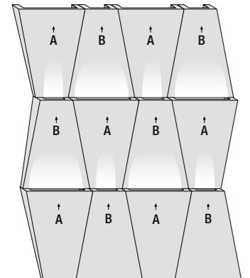
ESEMPIO 2 - MONTAGGIO PER OTTENERE FONTI LUMINOSE ALTERNATE
