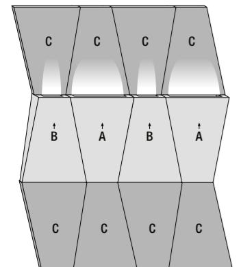
ESEMPIO 1 - MONTAGGIO PER OTTENERE ALTERNANZA LEGNO-METALLO SULLA STESSA LINEA
