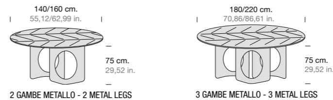
**DEG4311K** Ø 140 cm. - Ø 55,11 in.**DEG4321K** Ø 160 cm. - Ø 62,99 in.**DEG4331K** Ø 180 cm. - Ø 70,86 in.**DEG4341K** Ø 200 cm. - Ø 78,74 in.**DEG4351K** Ø 220 cm. - Ø 86,61 in.
